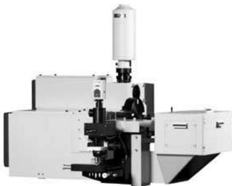
Figura 16: Espectrômetro Yvon Jobin modelo T64000 equipado com um detector CCD resfriado com nitrogênio líquido e um microscópio confocal Olympus modelo BX40.
