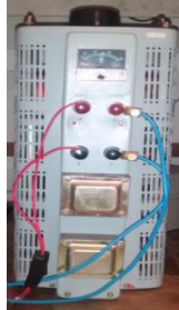
Figura 6.9 VARIAC TDGC2-30. Entrada: 127/220 vca, capacidade: 15 KVA/220 Vca, saída: 0-140 Vca / 0-250 Vca, corrente de saída: 120 A. CARACTERÍSTICAS[1]
