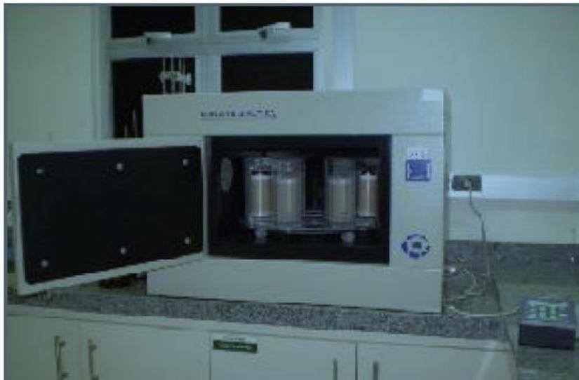
**Figura 4-** Forno de microondas Provecto Analítica, DGT 100 PLUS
