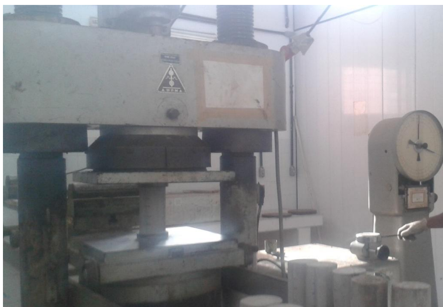
Figura 4 – Prensa hidráulica analógica
