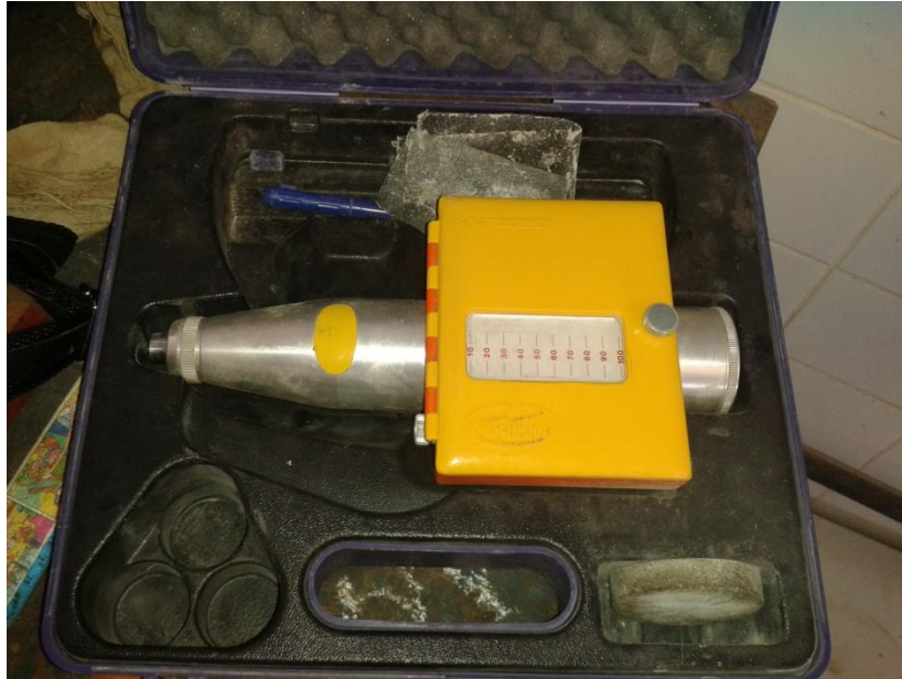
Figura 3 – Equipamento de esclerometria, Original Schmidt N/NR .
