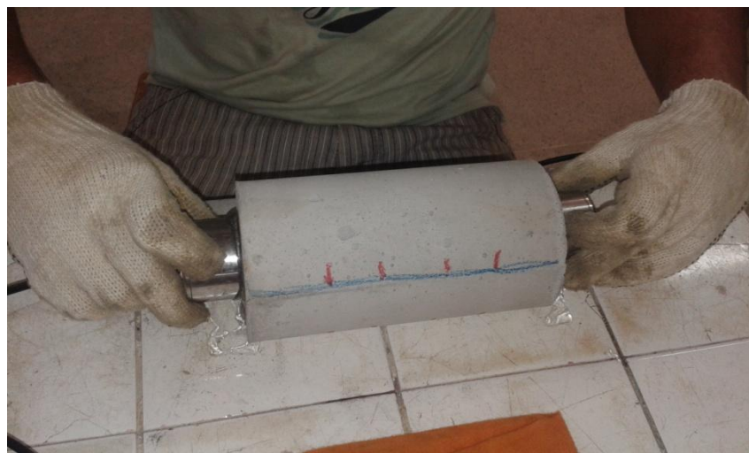
Figura 8 – Procedimento do ensaio de ultrassom.
