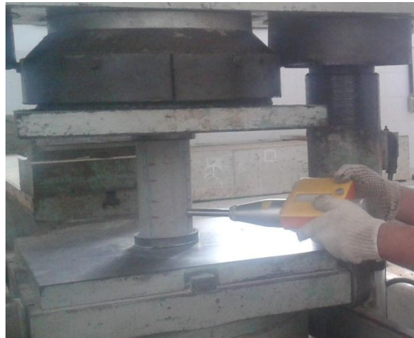
Figura 9 – Procedimento do ensaio de esclerometria
