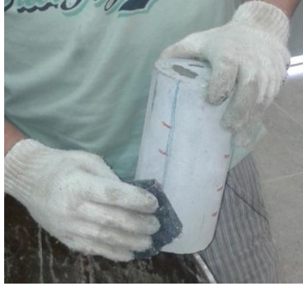
Figura 7 – Lixamento para regularização do CP.
