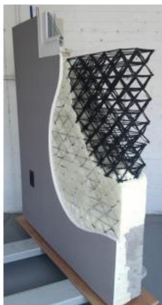
Figura 15 – Compósito impresso em 3D para função estrutural
