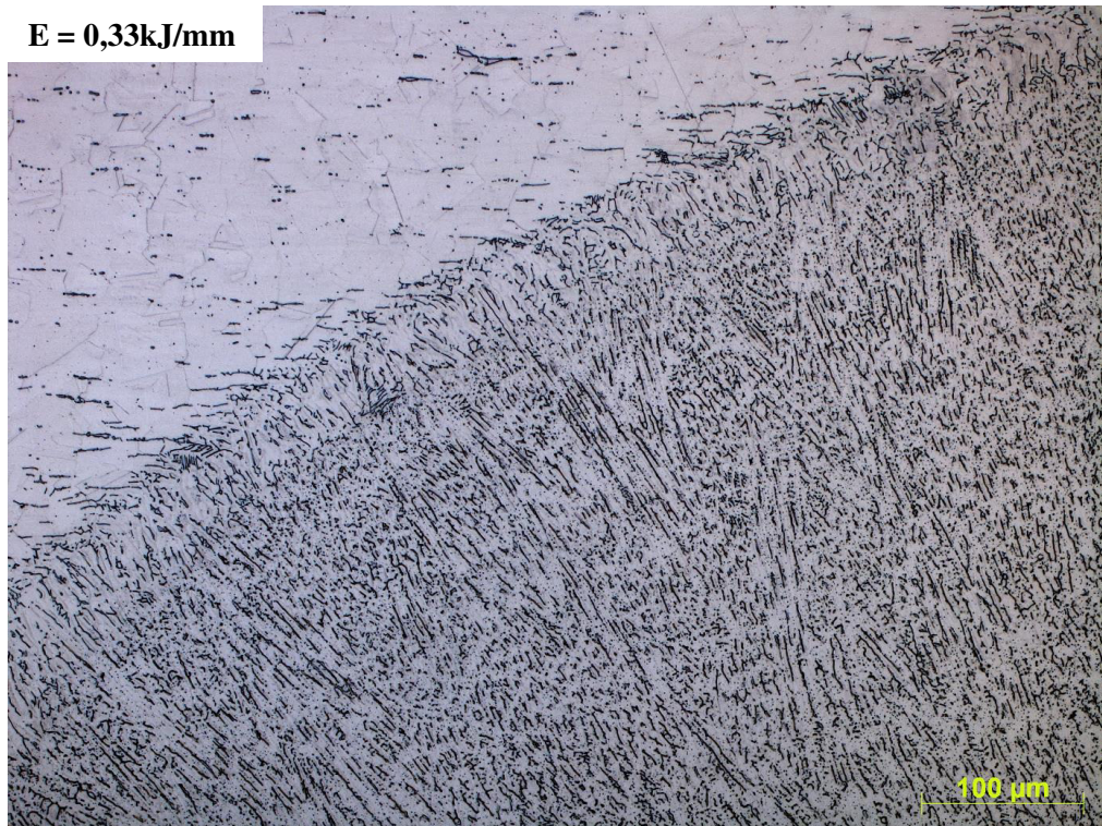
Figura 50 – Micrografias em 200x da interface ZF - ZAC para a amostra A1 (AISI 304).
