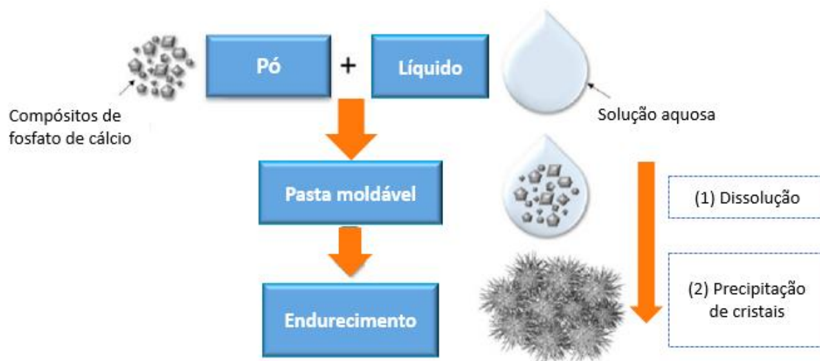
Figura 3 – Preparo e processo de endurecimento dos biocimentos de fosfato de cálcio.
