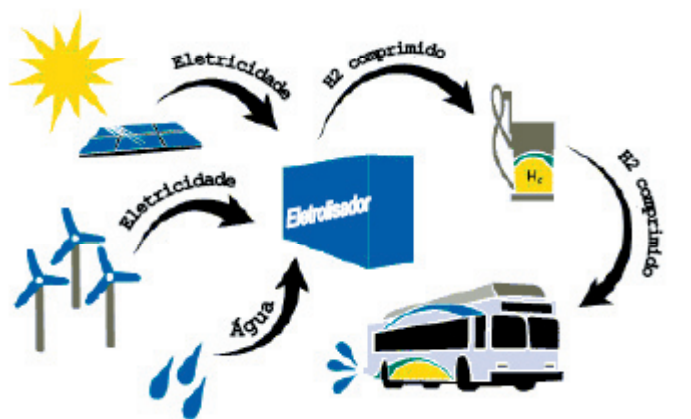
Figura 01: Representação do funcionamento básico da transformação de energia oriunda de fontes renováveis para hidrogênio e sua opção como combustível no setor de transportes (Fonte:FRANK, 2005).
