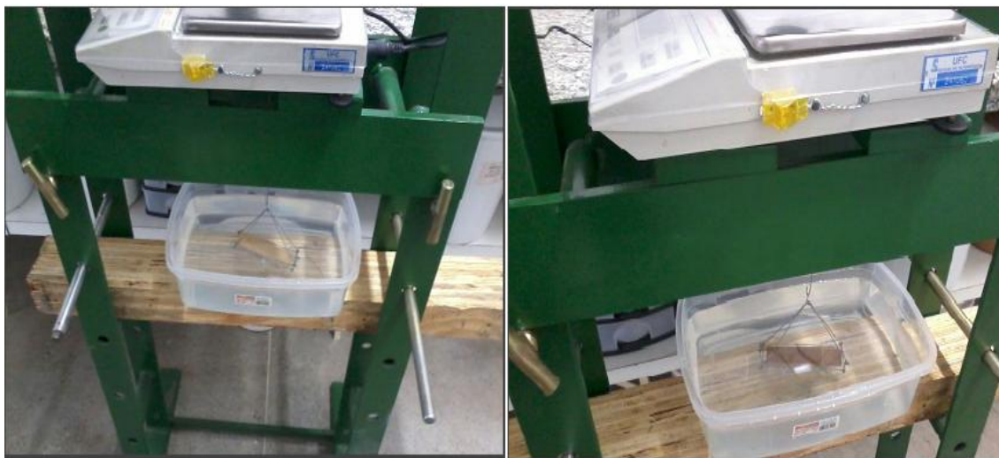
Figura 09- Ensaio de Massa Específica Aparente e Porosidade Aparente.
