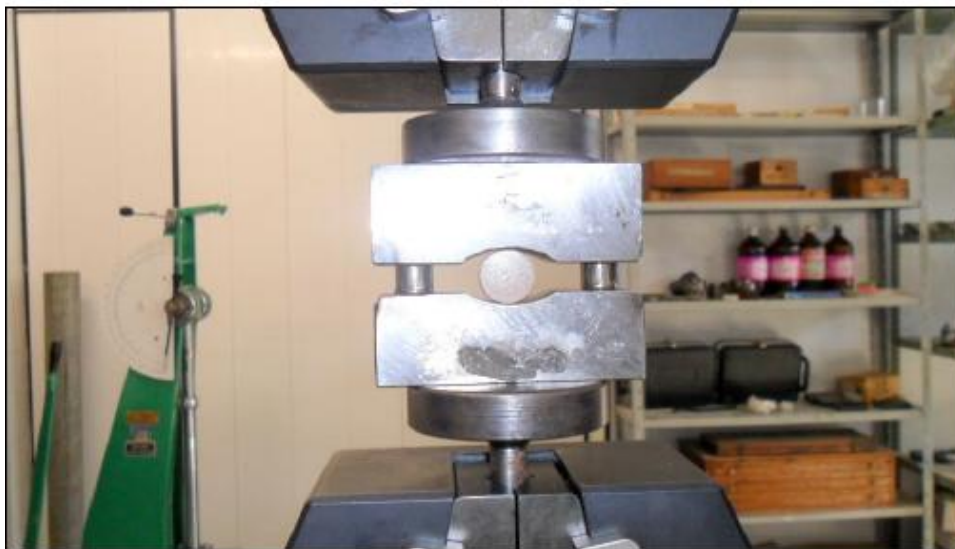
Figura 12- Corpo de prova em posição antes do início do ensaio de compressão diametral após aplicação de uma pequena carga de compressão para acoplamento.
