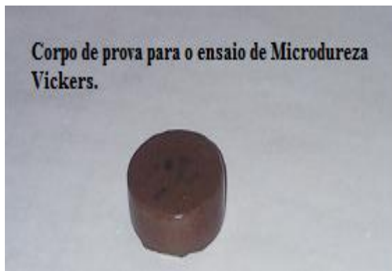
Figura 10 – Corpo de prova utilizado no ensaio de microdureza Vickers.
