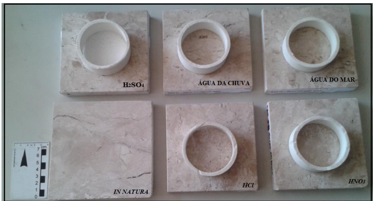
Figura 3.12 Corpos-de-prova do Bege Bahia com as substâncias acidificadas
