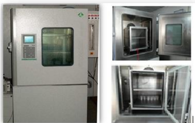
Figura 3.40 Câmara de climatização (FITOCLIMA 300 EDTU) usada no ensaio
