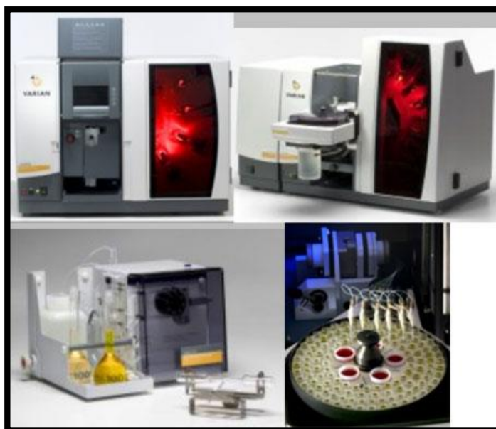
Figura 3.16 Espectrofotômetro VARIAN, modelo AA 280FS
