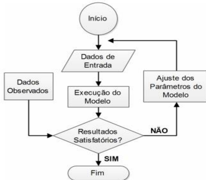
Figura 16 – Esquema do processo de calibração.
