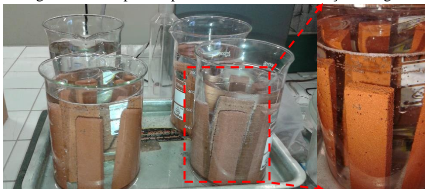
Figura 12 – Corpos-de-prova em ensaio de absorção de água.
