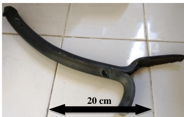
Figura 21 - Barra laminada com separação de extremidades por perda de ductilidade a quente.
