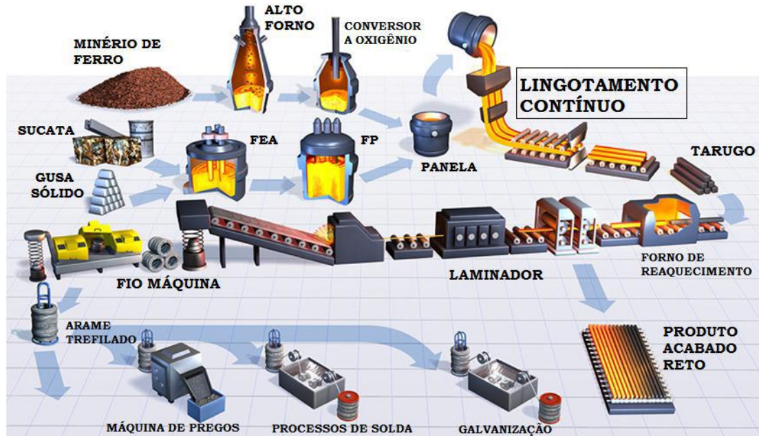
Figura 1 - Fluxo simplificado do processo siderúrgico de produtos longos.
