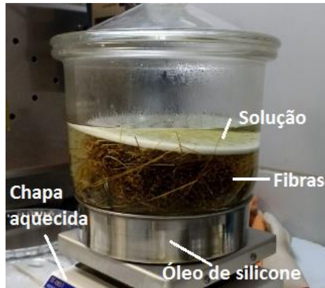
Figura 18: Reator utilizado para realizar a acetilação das fibras.
