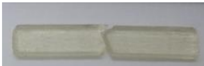
Figura 58: Ruptura do corpo de prova de 100% Resina no ensaio de impacto.
