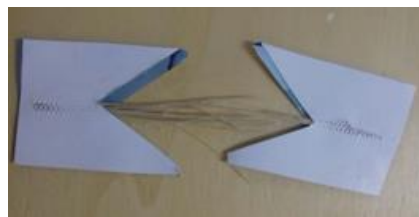
Figura 45: Fibra rompida após o ensaio de tração.
