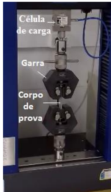
Figura 32: Ensaio de tração.
