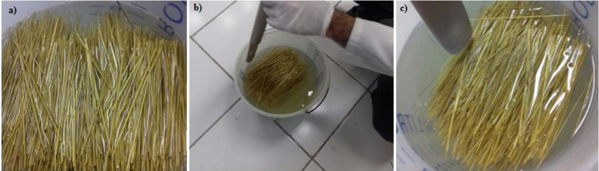
Figura 16: Processo de alcalinização das fibras.
