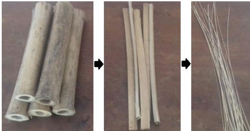
Figura 14: Processo de obtenção das fibras de bambu.
