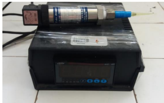
Figura 21 - Medidor de pressão usado no ensaio BMP.
