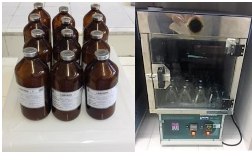
Figura 20 – Ensaio de BMP: Shaker orbital e frascos de 250mL
