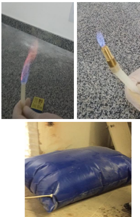
Figura 35 - Chama observada durante queima do biogás gerado armazenado no bag
