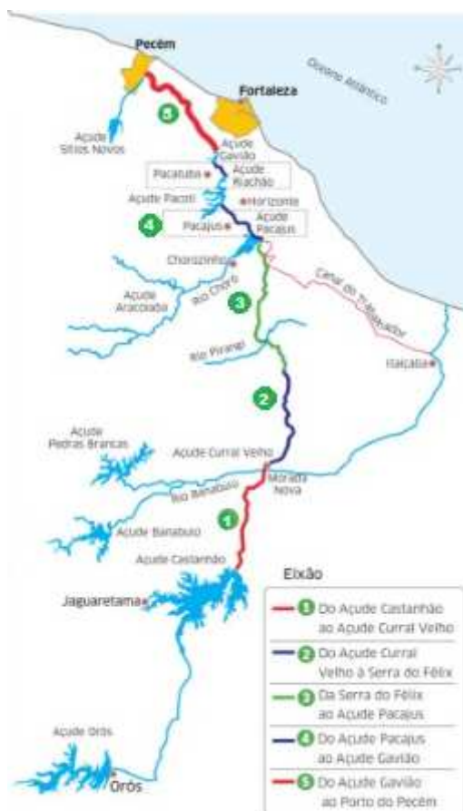
Figura 1 - Sistema de Abastecimento de Água da RMF
