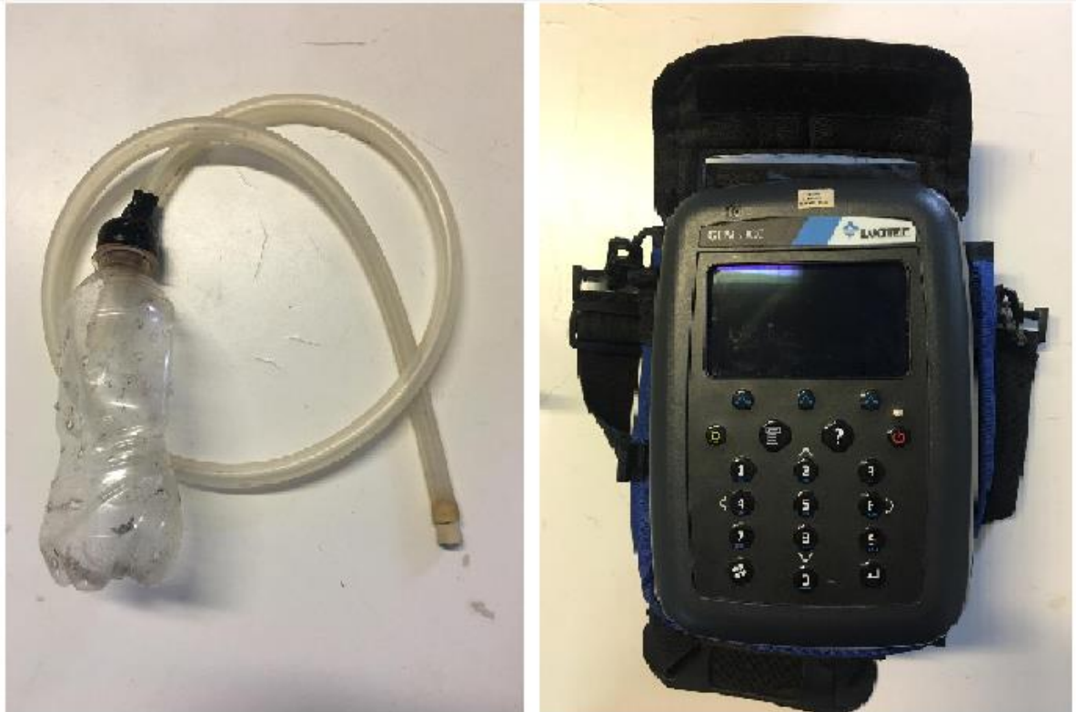
Figura 22 - Detalhe do sistema de drenagem e equipamento GEM 5000
