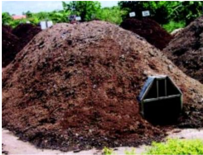
Figura 5 - Leira estática com túnel de ventilação
