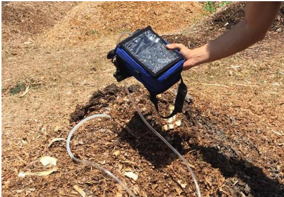
Figura 21 - Leitura dos gases na leira EP100 com GEM 5000
