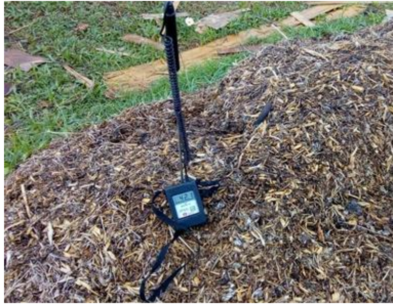
Figura 19–Termopar para monitoramento da temperatura das leiras de compostagem
