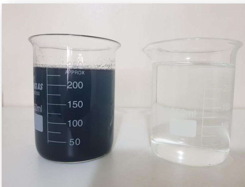
Figura 35 - Imagem do efluente bruto e tratado pelos processo eletrolítico
