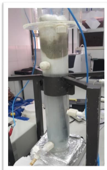
Figura 16 - Imagem do reator de acrílico tratando o efluente através de processo eletrolítico
