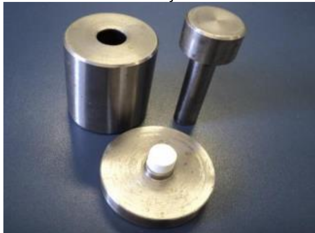
Figura 3.2 – Molde cilíndrico de aço carbono usado na prensagem dos pós.
