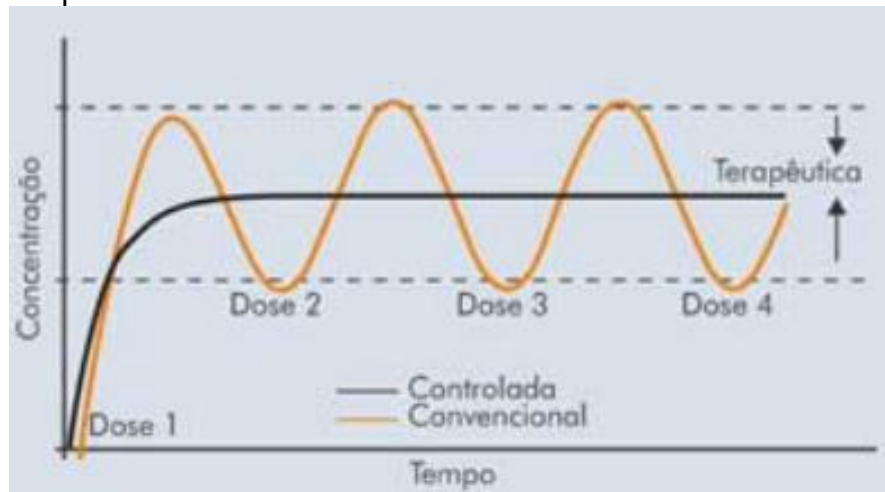
Figura 2.4 - Esquema do Perfis de liberação de fármacos em função do tempo: controlada versus convencional.
