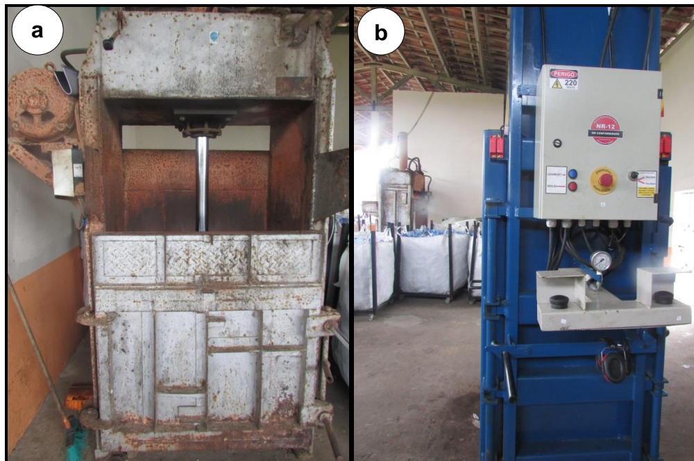
Figura 18 - Maquinário da usina de reciclagem, (a) pré prensa, (b) prensa.
