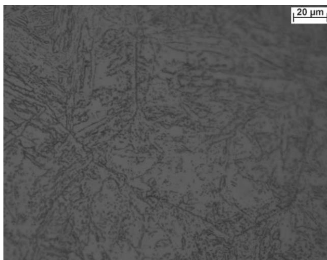
Figura 4 - Micrografia óptica do aço inoxidável martensítico UNS S41000. Reagente de ataque: Villela.
