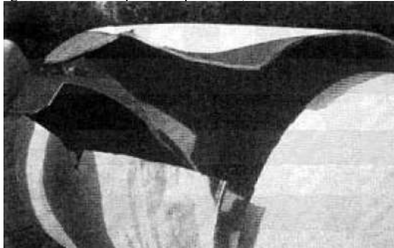
Figura 15 - Vaso de pressão após falha, mostrando fratura dúctil
