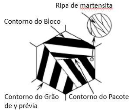
Figura 24 - Hierarquia microestrutural da estrutura martensítica em ripas e morfologia da nucleação martensítica.
