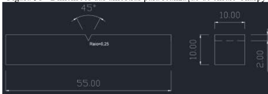
Figura 51 - Dimensões das amostras para realização de ensaio Charpy
